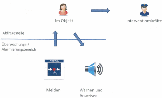
Prinzipieller technischer Aufbau einer Lösung im Grad 1 (Für Anwendungen mit erinzem Risiko )
